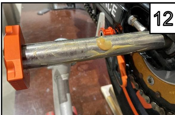
Geben Sie nun etwas Schmierfett auf die Steckachse und verschmieren Sie diese gleichmäßig. Im Anschluss können Sie die Steckachse wieder in das Hinterrad einführen. /
