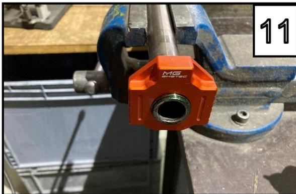
Drehen Sie nun den Kettenspanne bis zum Ende des Gewindes (Achtung: Steckachse hat keinen Gewindeanschlag – nur Handfest anbringen, da ansonsten das Innengewinde des Kettenspanners beschädigt wird.) /
