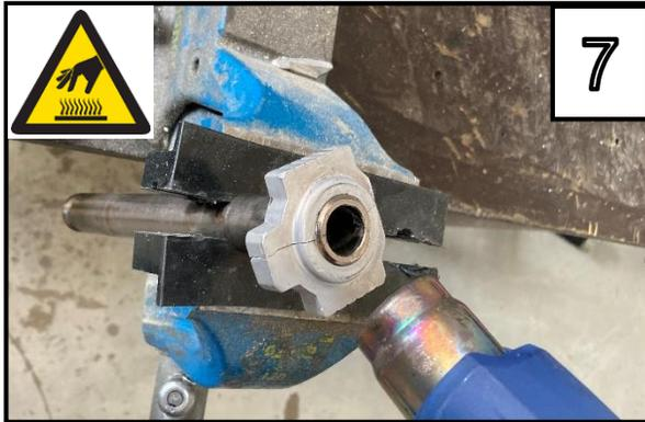
Der originale Kettenspanner ist mit einem hochfestem Kleber befestigt. Durch Erhitzen des Kettenspanners mit einem Heißluftföhn, sollte der Kettenspanner danach leichter runter gehen. Achten Sie wie hier im Bild, wenn die Achse in einem Schraubstock befestigt wird, dass hier Kunststoff oder Gummieinlagen verwendet werden um Kratzer oder Verformungen an der Achse zu vermeiden. /
