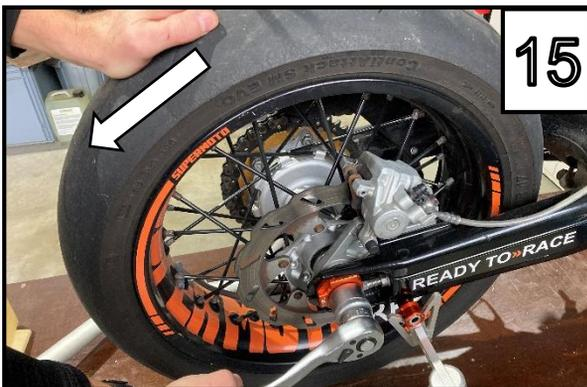
Drehen Sie nun das Hinterrad fest nach hinten und ziehen Sie die mitgelieferte Kontermutter fest laut Herstellerangaben. Im Anschluss entfernen Sie noch den Motorradständer./
