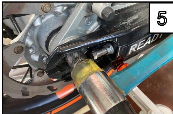
Schieben Sie nun die Steckachse auf dieser Seite raus (Optional wie im Bild gezeigt eine Gummihammer verwenden – Achten Sie darauf das Gewinde an der Steckachse nicht zu zerstören). /
