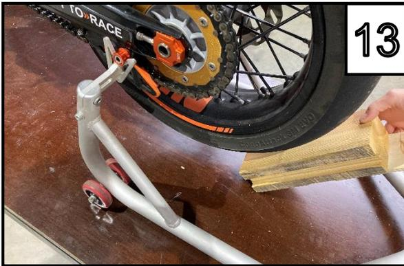
Entfernen Sie nun die Unterlage des Hinterrreifens. Der MG Biketec Kettenspanner hat die gleichen Außenmaße an den Stellen für die Stellschraube. Sofern die Spannung an der Kette davor gepasst hat, müssen sie die Spannung an der Kette nicht mehr verändern – Kettenspannung kontrollieren und gegebenenfalls auch verändern. /
