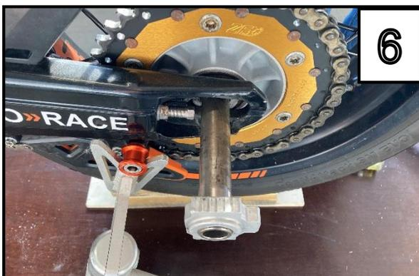
Ziehen Sie nun die Steckachse auf der anderen Seite komplett heraus. (Sofern das Hinterlegt richtig unterlegt wurde, sollte dies sehr leicht heraus gehen). /
