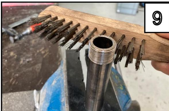
Nachdem alles abgekühlt ist, reinigen Sie nun die beiden Gewindestellen mit einem geeigneten Werkzeug von den Kleberesten (z.B.: Drahtbürste). /
