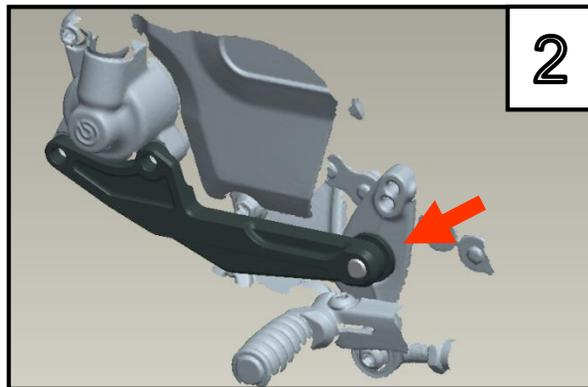
Die MG Schaltwellenabstützung mit dem Lager in die
