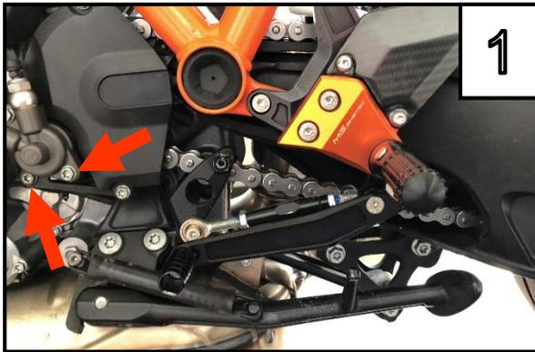
Entfernen Sie die 2 Schrauben /
