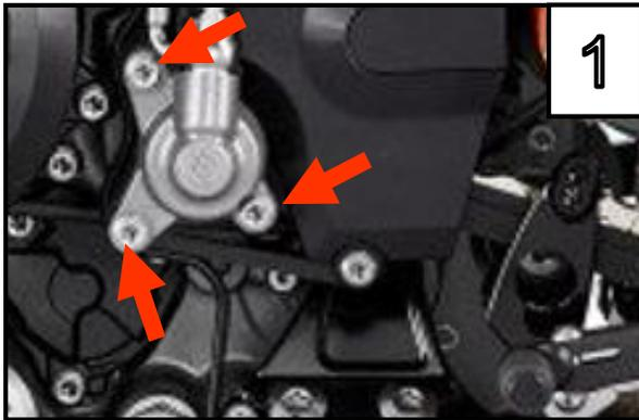
Entfernen Sie die 3 Schrauben /
