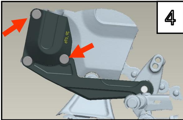
Befestigen Sie die beide Teile mit der restlichen Schrauben.
