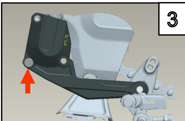
Befestigen Sie die Teile mit der mitgelieferte Schraube.
