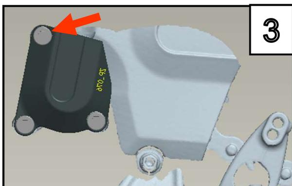
Befestigen Sie die Abdeckung mit der mitgelieferten Schraube.
