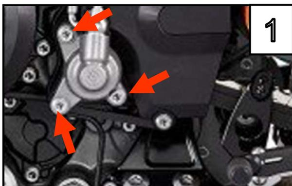
Entfernen Sie die 3 Schrauben /
