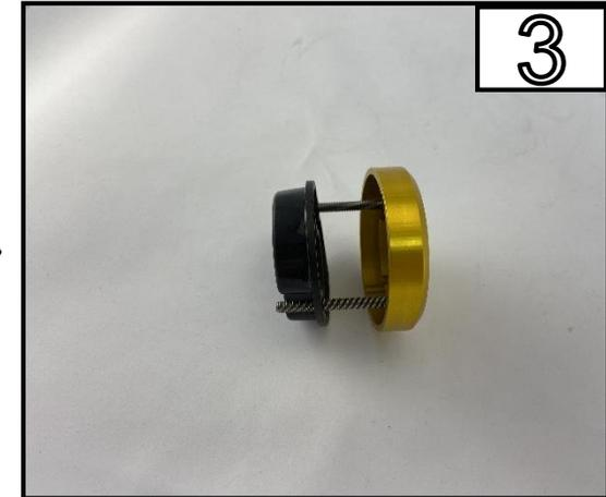
Öffnen Sie die beiden im Bild gezeigten Schrauben und entfernen Sie den originalen Bremsflüssigkeitsdeckel /
