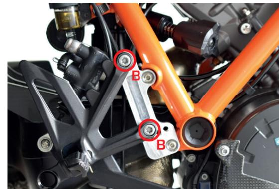
Befestige die originale Rastenanlage an der Adapterplatte an den Schraubpunkten **B** mit 25Nm und Schraubensicherung. Sollte die Leitung zum Ausgleichsbehälter zu kurz sein, verwende den B-Adapter und die beiden Schrauben M5 x 15 um die Behälter umzusetzen.
