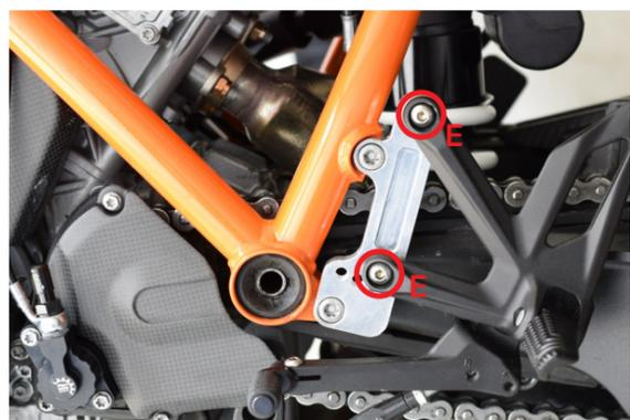
Befestige die originale Rastenanlage an der Adapterplatte an den Schraubpunkten **E** mit 25Nm und Schraubensicherung.
