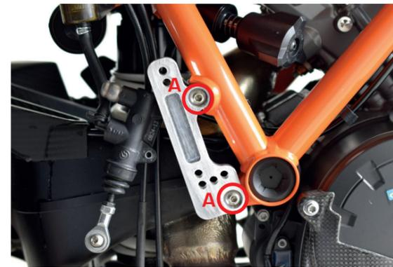
Installiere die rechte Adapterplatte an den Schraubpunkten **A** mit den mitgelieferten Schrauben M8x25. Bitte stelle die Fußraste auf Deine gewünschte Position ein und befestige die Fußraste mit den originalen Schrauben, 25Nm und Schraubensicherung.
